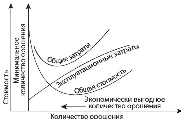
Рис. 3.7. Изменение затрат в зависимости от количества орошения в ректификационной колонне
